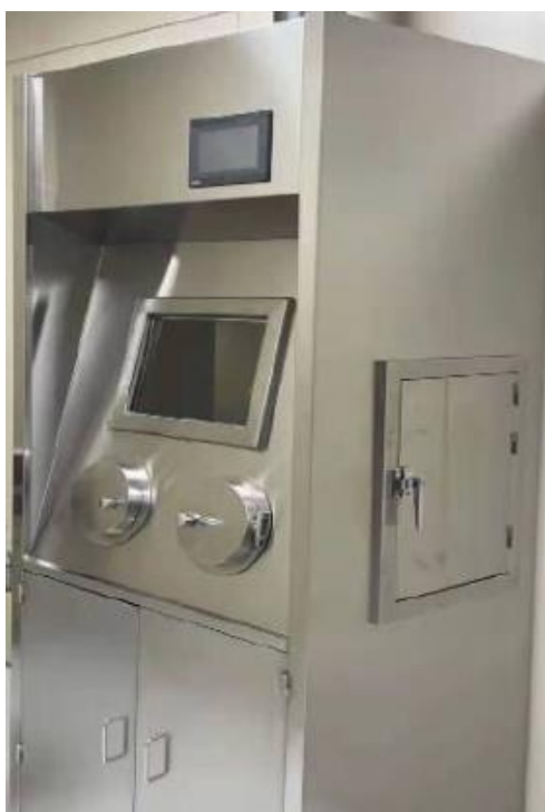
图 10-2 专用通风橱（手套箱式）示意图
